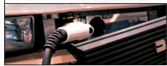
La calandre s'ouvre afin de pouvoir brancher la prise de courant.
